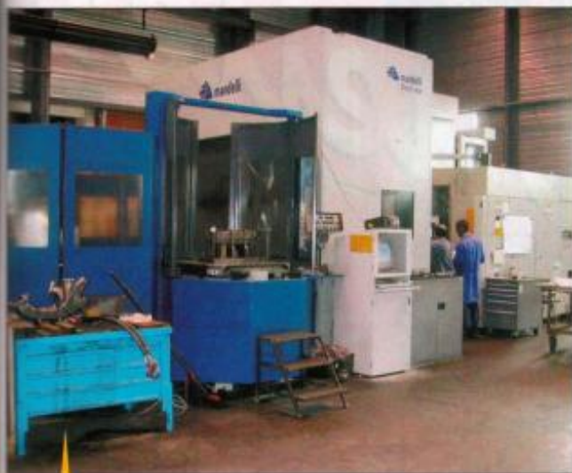
CE CENTRE D'USINAGE MANDELLI STORM 1400 TRAVAILLE EN 3X8 H. PARFOIS MÊME LE SAMEDI. IL EST APPRÉCIÉ POUR SA PRÉCISION ET SA FLEXIBILITÉ DE PRODUCTION.
