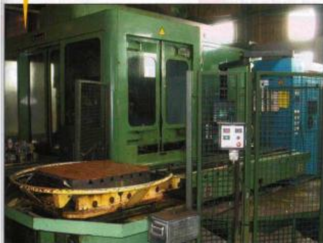
LE CENTRE D'USINAGE MANDELLI 8H EST EN SERVICE DEPUIS 1995. DESTINÉ AUX USINAGES DES CULASSES, IL EST ÉQUIPÉ D'UN CHANGEUR AUTOMATIQUE DE PALETTES À 2 POSTES.
